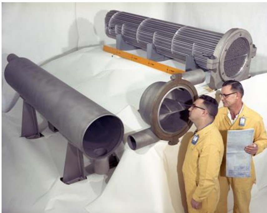
Figure 8 : Vue des échangeurs.
