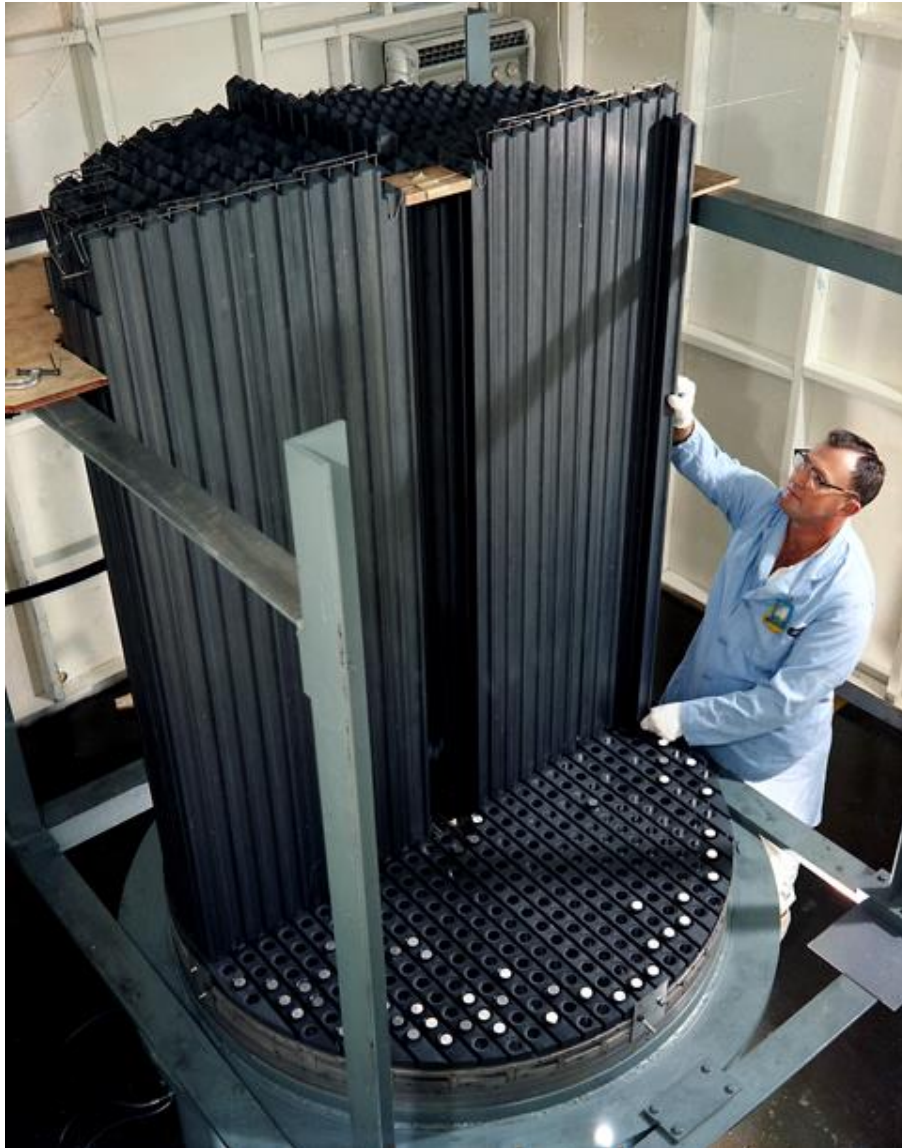
Figure 6 : Vue des éléments graphite du cœur MSRE.
